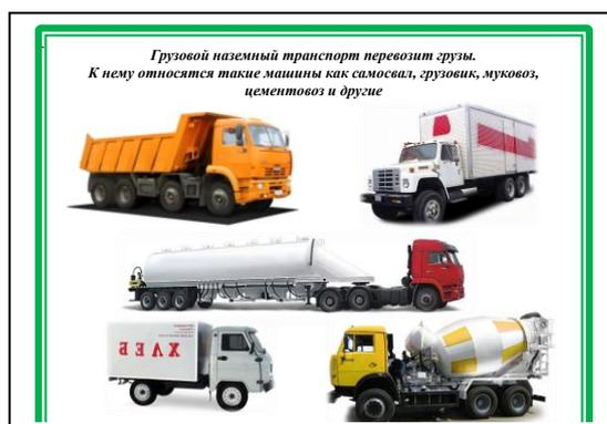
Грузовой наземный транспорт перевозит грузы. К нему относятся такие машины как самосвал, грузовик, муковоз, цементовоз и другие.
